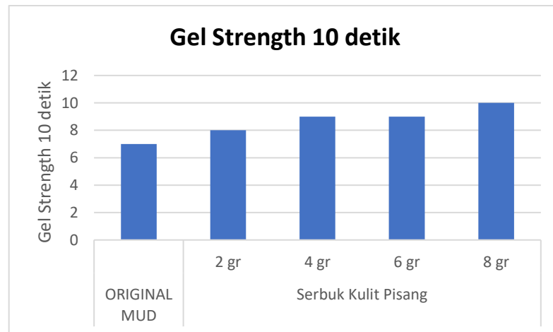
Gambar 4.1 4 Grafik Perubahan Gel Strength 10 detik
